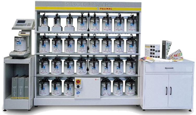
Das System POLYPAL 607 MULTIFUNCTION besteht aus konzentrierten Basen. Durch Hinzufügen anderer spezifischer Bindemittel können Lacke unterschiedlicher Qualität hergestellt werden: CHLORKAUTSCHUK, EPOXYDVINYL, GLÄNZENDE, EPOXY, NITROAKRYLIK, NITROKÜNSTHARZ, POLYURETHAN, SILIKON- UND EISEN-/GLIMMERARTIGE LACKE, USW.
