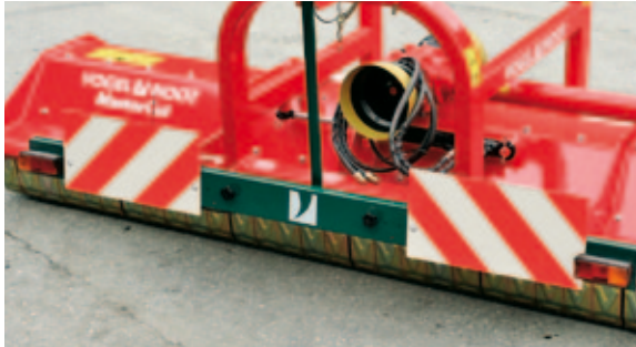
Lichtanlage mit Warntafeln
