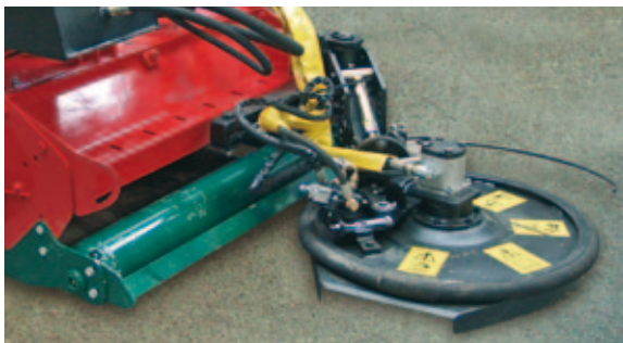
Mähscheibe zu TSA mit Taster und eigenem Ölhaushalt
