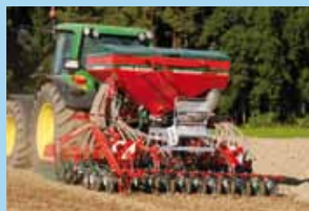
MasterDrill pro A Aufbau-Geräte (Kreiseleggen, etc.) 3,00 / 4,00 / 4,50 m
