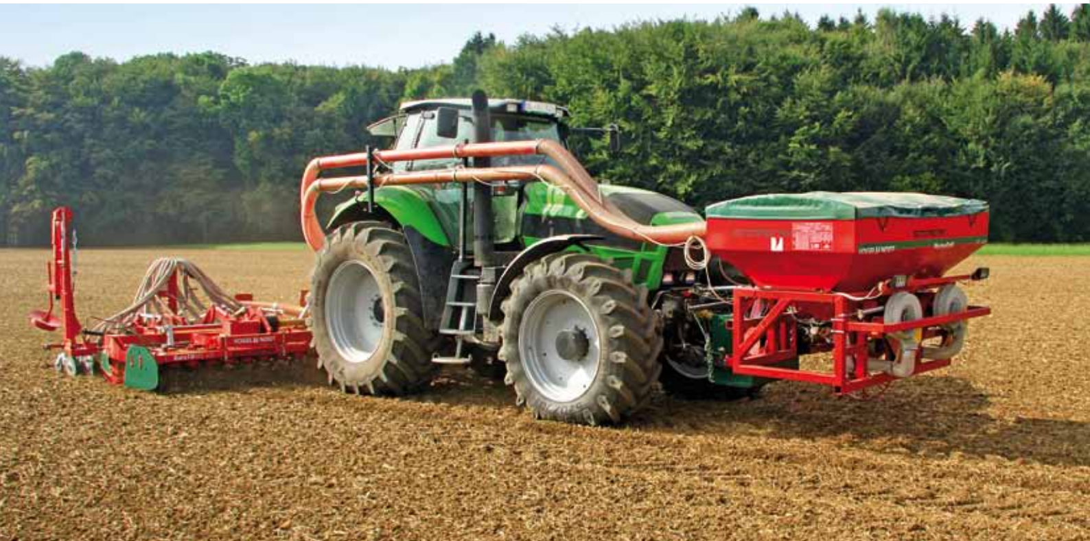
MasterDrill FT2-M in Verbindung mit klappbarer Kreiselegge
