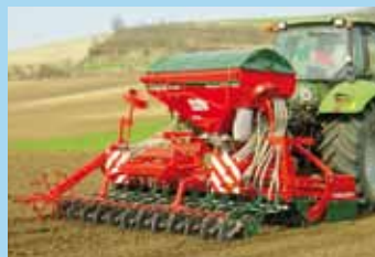
MasterDrill A Aufbau-Geräte (Kreiseleggen, etc.) 2,50 / 3,00 / 4,00 / 4,50 m
