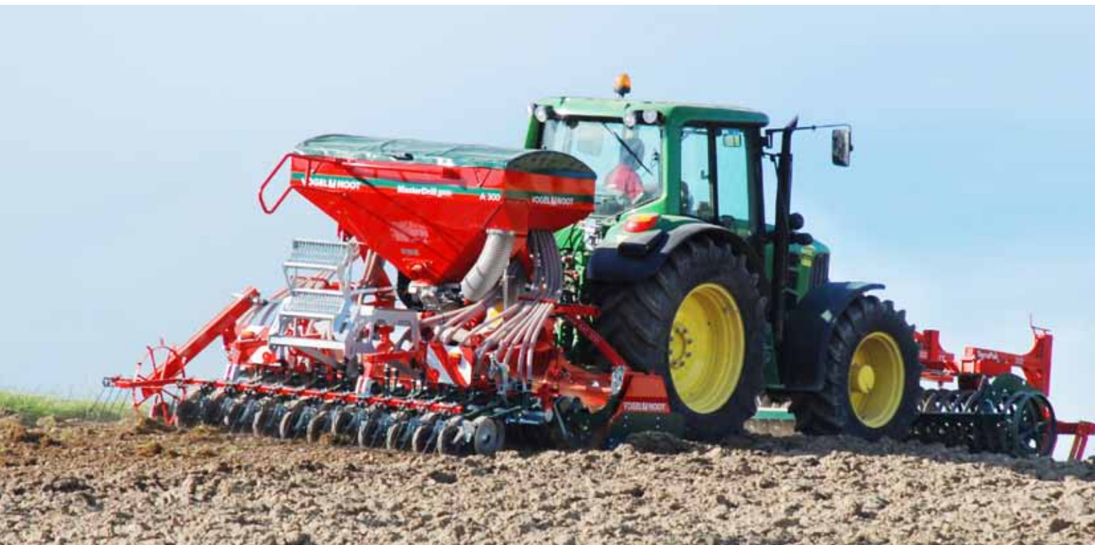
MasterDrill pro A 300 mit Doppelscheibenscharen und Druckrollen
