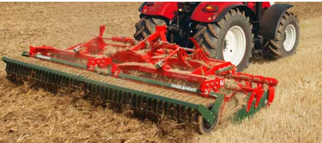
Die kostengünstige und schlagkräftige Lösung in der modernen Bodenbearbeitung. Konzipiert für die flache Bodenbearbeitung zwischen 2 und 12 cm sorgt sie sowohl bei der Stoppeln als auch der Mulchbearbeitung für eine optimale Einmischung, Krümelung und Rückverfestigung.
