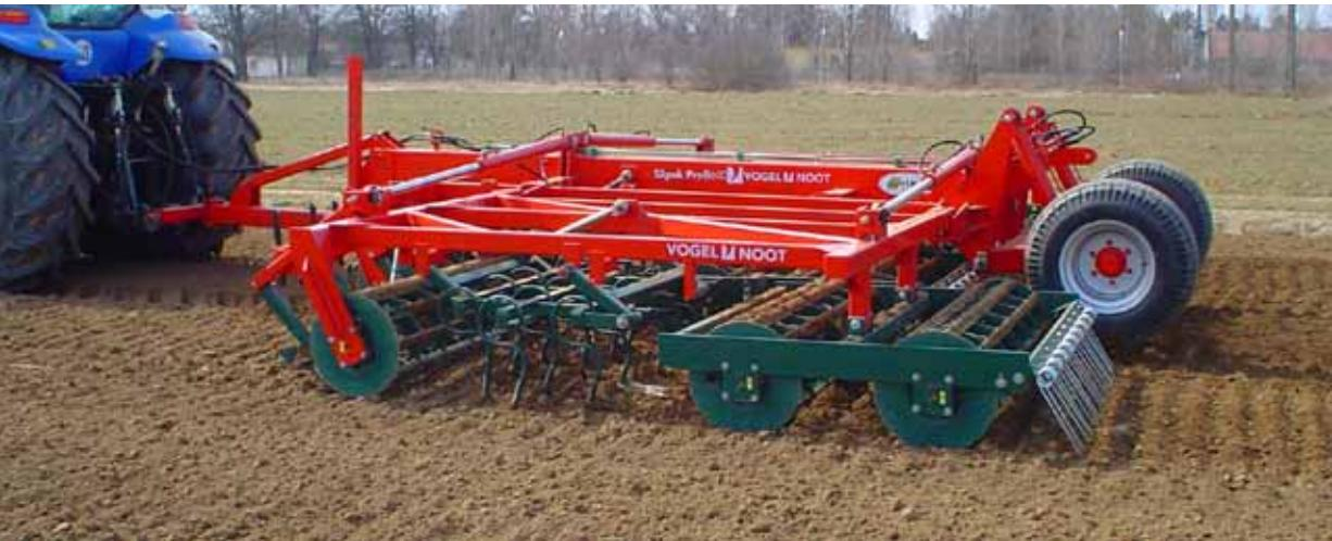
2 Baureihen für die für die Saatbettbereitung bis 15 cm Arbeitstiefe: Ein-ebnung durch Schlepp-schiene, Krümelung und Lockerung durch Qualitäts-Federzinken und Boden-strukturierung durch Doppelkrümelwalzen.
