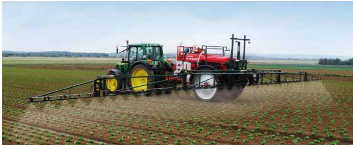
Die VN-Feldspritzen überzeugen durch perfekte Technik. Als Anbauspritzen oder als gezogene Version sind Arbeitsbreiten von 12 - 30 m möglich. Innovative Ausstattungsdetails sorgen für sicheres Handling und maximalen Komfort. Tankvolumen bis 4600 l.
