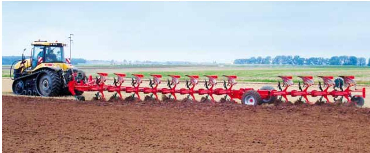
Die VN-Auf-sattel-Dreh-pflüge sind für maximale Leistungen entwickelt. Mit bis zu 12 Scharen, ermöglichen sie enorme Arbeitsbreiten und Flächenleistungen. Die robuste Technik wurde tausendfach unter extremsten Einsatzbedingungen auf Großflächen erprobt.
