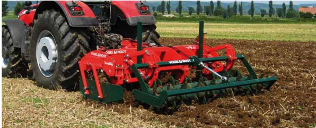
Die robusten Untergrund-lockerer brechen zuverlässig Verdichtungen im Unterboden auf und sorgen durch die Bodenbelüftung für intensives Bodenleben und verbessertes Pflanzenwachstum.
