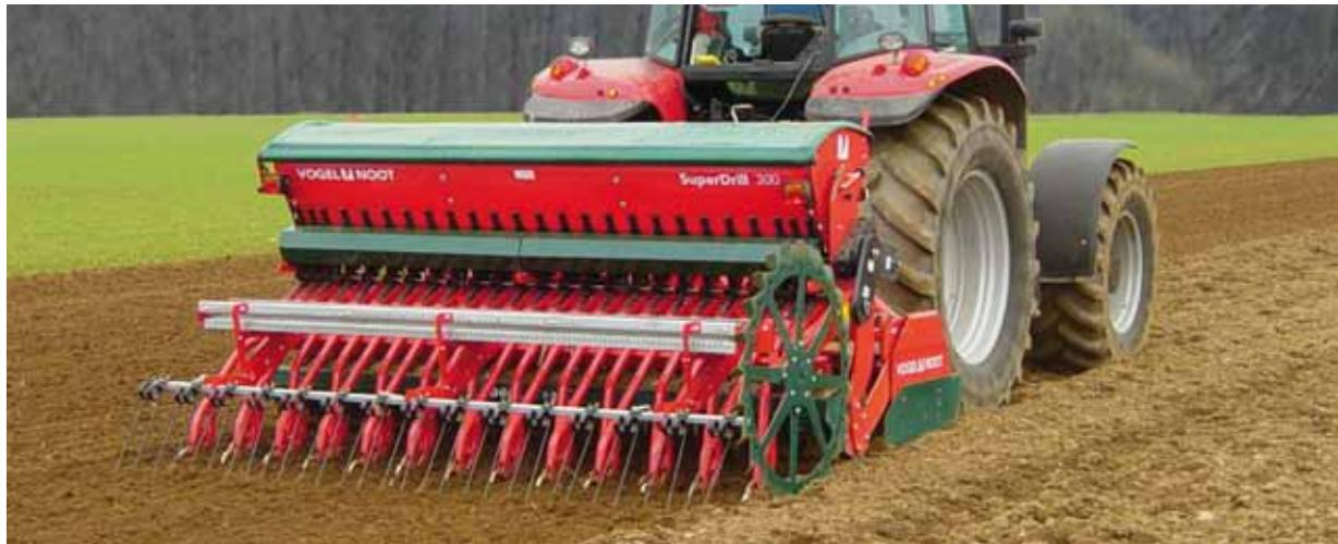
Die mechanischen SuperDrill-Sämaschinen überzeugen durch ihre einfache und robuste Konstruktion. Sie sind leicht zu bedienen und legen das Saatgut präzise ab. Verfügbar als Anbau- oder Aufsatzerät zur Kombination mit Kreisleggen.
