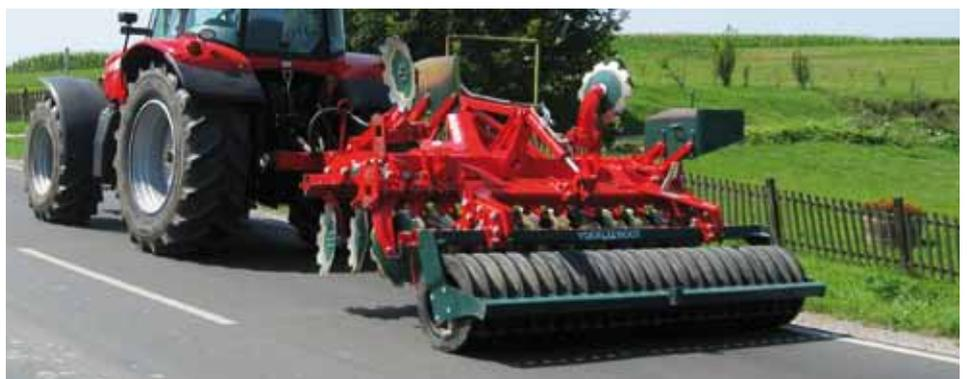
Die TerraDisc<sup>pro</sup> TR ist verfügbar mit 3,00, 3,50\* sowie 4,00\* Metern Arbeitsbreite in starrer Rahmenbauweise
