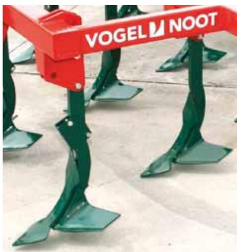
Diese Kombination ist gleichermaßen geeignet für die mitteltiefe Bearbeitung von schweren Böden als auch für die flachere Mulchsaatbettbereitung. Der verstellbare Eingriffswinkel des Flügelschars garantiert besten Einzug auch in harte Böden. Leitbleche an den Zinken der ersten Reihe verbessern den Erdfluss.
