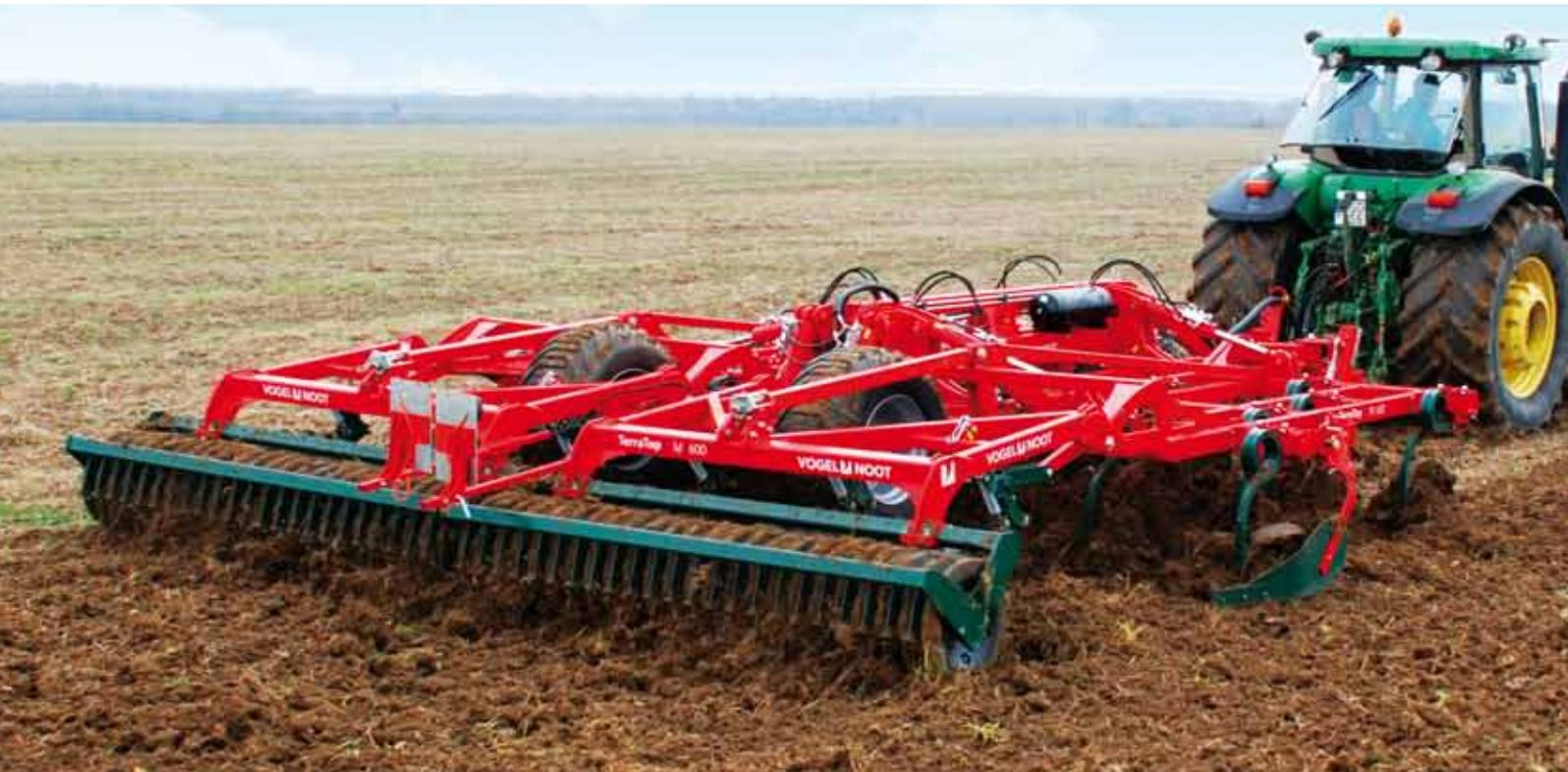
TerraTop M 600 mit serienmäßigen Spiralfederzinken und Gummikeilringwalze
