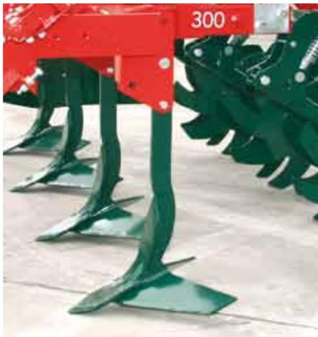
Diese Kombination sorgt für eine hervorragende Mischung in leichteren Böden oder bei geringen Arbeitstiefen.
