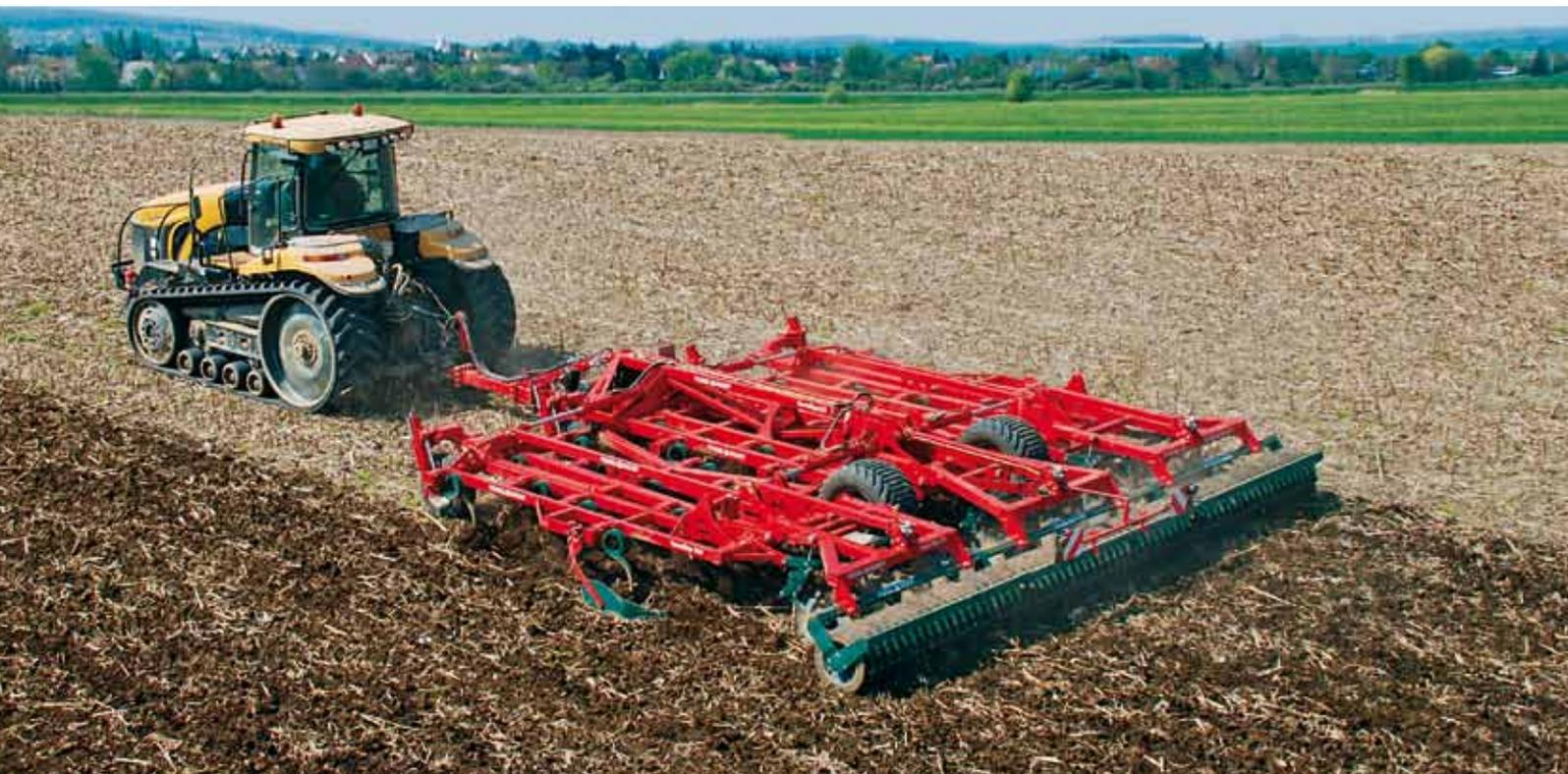
TerraTop 800 S mit serienmäßigen Spiralfederzinken und Gummikeilringwalze
