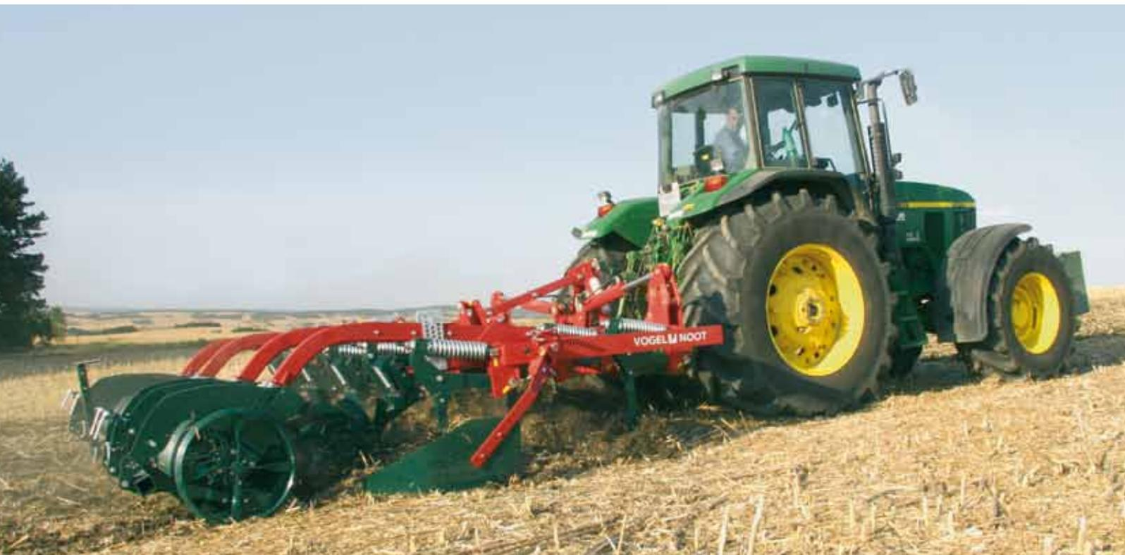
TerraFlex 400 klappbar mit NonStop-Sicherung mit Zusatzfeder und Terrapak-Walze
