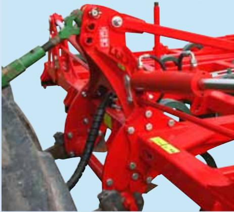
Der komplett überarbeitete Anbauturm zeichnet sich durch eine 3-fach verstellbare Position des Oberlenkerbolzens aus. Gleichzeitig ist auch die Anbauachse serienmäßig in 2 Höhen verstellbar, passend für die bekannten VN Anbauachsen von Kategorie 2 bis 4N. Diese Flexibilität ermöglicht die optimale Anpassung an verschiedene Schlepper. Hubkraftbedarf und Schlupf werden reduziert.
