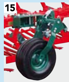
15 Rad-Ø 680 mm luftbereift x 250 mm Breite - VORNE montiert, schwere Ausführung (doppelstielig). Verfügbar für: Für alle 5- und 6-scharigen Pflüge
