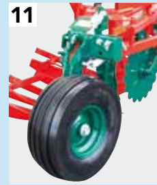
11 Rad-Ø 680 mm luftbereift x 250 mm Breite Verfügbar für: XMS/XS (nicht für 6-scharige sowie 5-scharige ST und/oder Vario-Pflüge)
