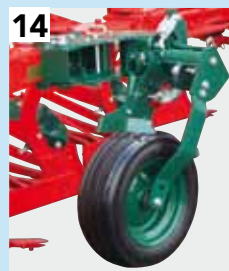
14 Rad-Ø 600 mm luftbereift x 220 mm Breite - VORNE montiert, schwere Ausführung (doppelstielig). Verfügbar für: Für alle 5- und 6-scharigen Pflüge
