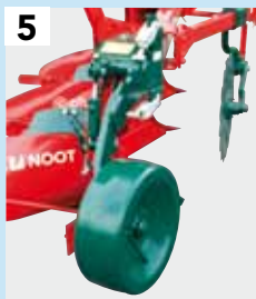
5 Rad-Ø 500 mm Blech x 185 mm Breite Verfügbar für: Alle Pflüge bis 4-scharig und Rahmenhöhe max. 78 cm
