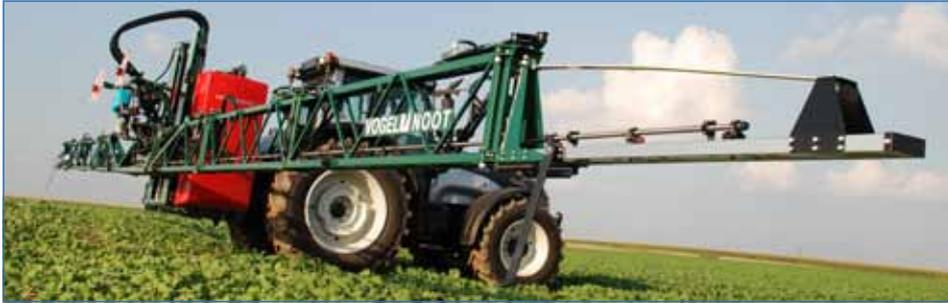
Dieses Gestänge wurde besonders flexibel konzipiert. Sämtliche Klapp-, Arbeits- und Höhenpositionen werden hydraulisch betätigt und über das Bedienterminal gesteuert.
