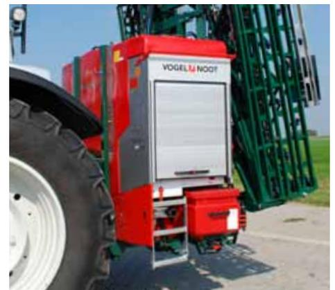
Die übersichtliche und komfortable Bedienzentrale befindet sich auf der linken Seite der Feldspritze und ist durch einen Rollladen geschützt. Somit gibt es keine Sicht- oder sonstige Behinderung durch offen stehende Türen. Abgerundet wird das Angebot durch ein integriertes schmutz- und spritzwassergeschütztes Staufach.
