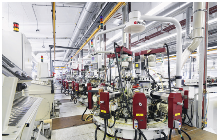
Auch auf sogenannten Hydromaten wird bei Rosenberger Hochfrequenztechnik im bayerischen Fridolfing gefertigt
