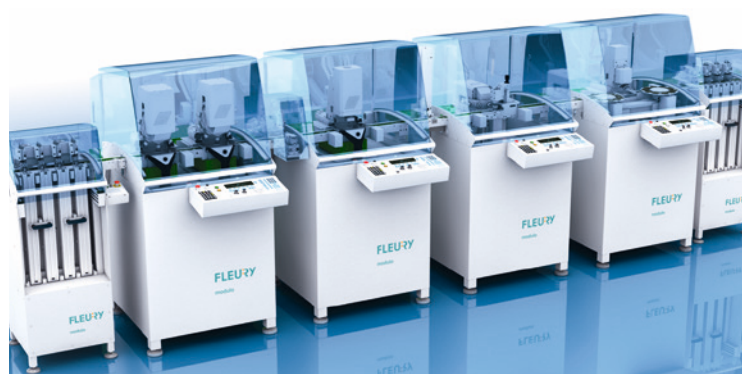
Kerngeschäft von Fleury bildet das Transfermaschinensystem Modulo, das wie ein Bausatz nach Kundenwünschen erweitert werden kann
