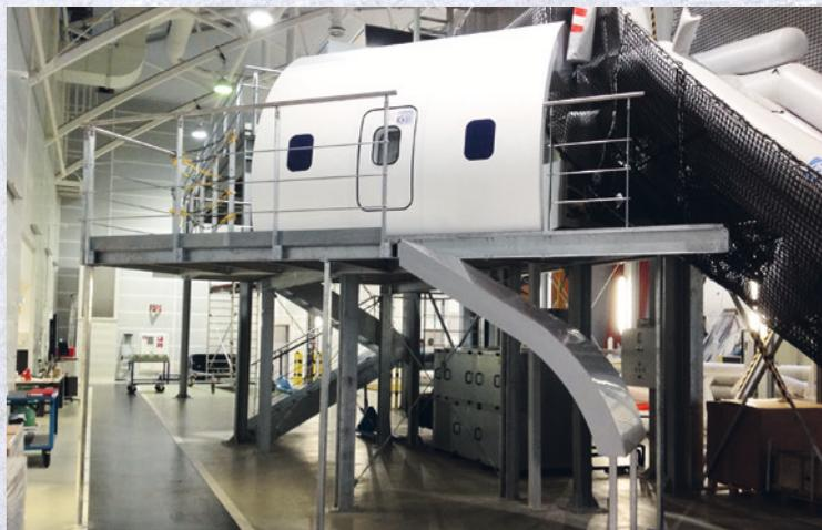
Knebel fertigt viele spezielle Vorrichtungen, wie diesen Emergency Door Trainer für die Lufthansa
