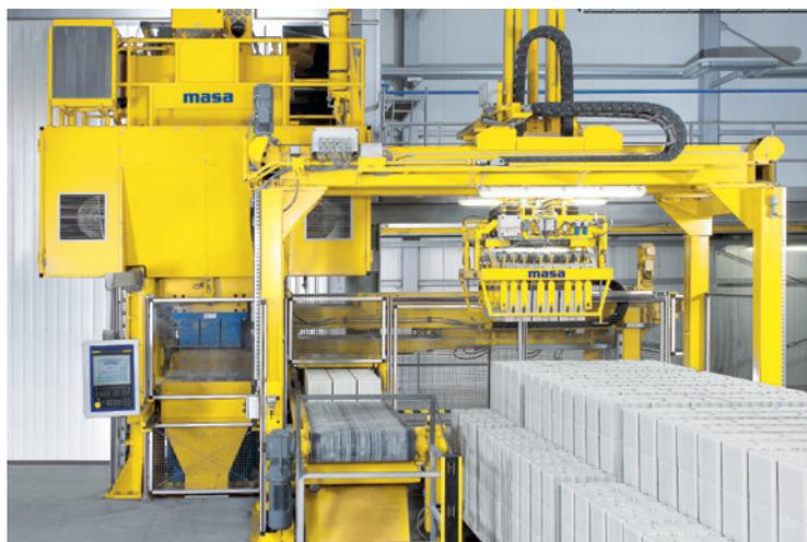
Hydraulische Masa-Kalksandsteinpresse mit Steinsetzautomat für Rohlinge
