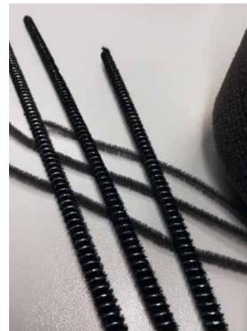
Technische Garne zur Geräuschdämmung oder gegen Vibrationen
