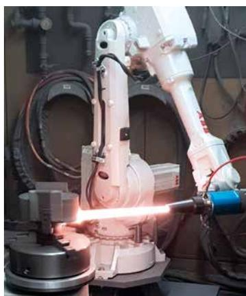
Die rhv-Technik setzt in verschiedenen Bereichen Roboter ein, unter anderem um komplexe Bauteilgeometrien effizient beschichten zu können
