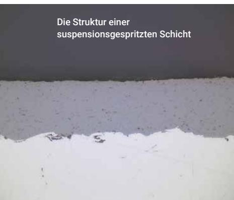
Neu im Portfolio ist das Suspensionsspritzen, über das neue Schichtsysteme entwickelt werden kann
