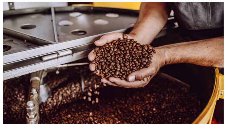
Sorgfalt braucht Zeit: Im Trommelröster werden die Kaffeebohnen langsam und schonend geröstet
