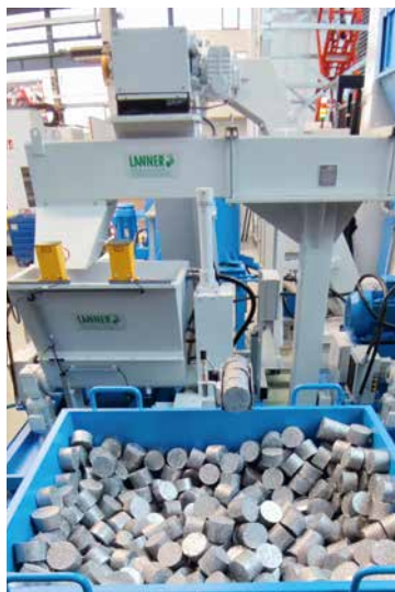
Referenzanlage zur Brikettierung von emulsionshaltigen Aluminiumspänen
