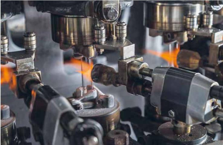
Mithilfe von Brennern werden die Glasampullen geformt
