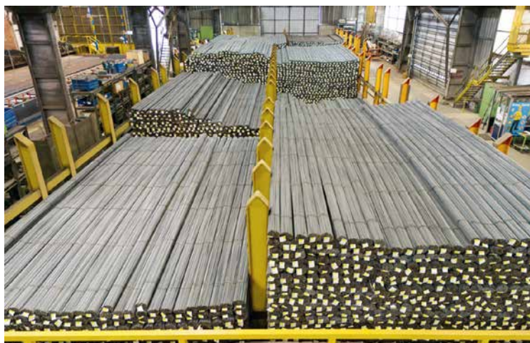
Betonstahlstäbe für Weiterverarbeitung
