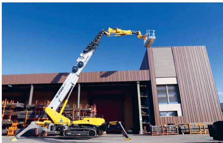
Die Raupenarbeitsbühne Spider 54T von Platform Basket erreicht eine Arbeitshöhe von 54 m und bietet optimale Lösungen für anspruchsvolle Einsätze
