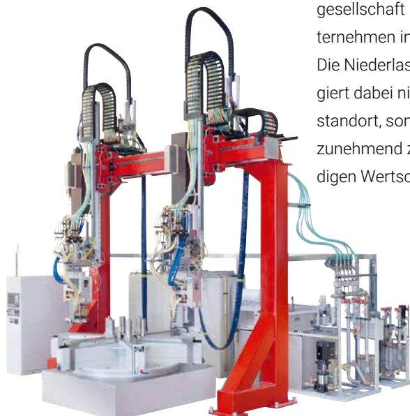
Portalhärteanlage der EMA Indutec GmbH zur präzisen Randschichthärtung von Zahnrädern – eine Schlüsseltechnologie für langlebige und hochbelastbare Komponenten in der Windindustrie
