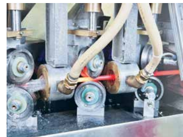
Induktive Stangenerwärmung: energieeffiziente und gleichmäßige Art der Erwärmung
