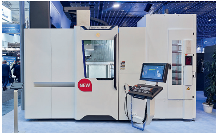
Die MILL P 800 U S ist ein 5-Achs-Bearbeitungszentrum für hochkomplexe Werkstücke, das auch bei großen Spanvolumina und langen Laufzeiten präzise und stabil arbeitet
