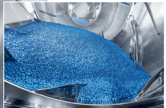
Innenansicht des Trommelcoaters mit 5%-Beladung (links); Innenansicht des Trommelcoaters mit 100%-Beladung (rechts): Beide Bilder zeigen gleichmäßig beschichtete Tabletten
