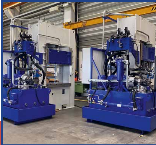
Retrofit: Zwei über 40 Jahre alte Pressen, die Pregler im Auftrag eines Kunden hydraulisch und steuerungstechnisch modernisiert hat
