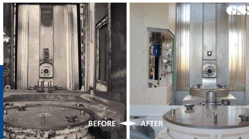
Überholung einer 4-Achs-Werkzeugmaschine – neben der Optik werden Funktion, Qualität und Zuverlässigkeit wiederhergestellt und erhöht
