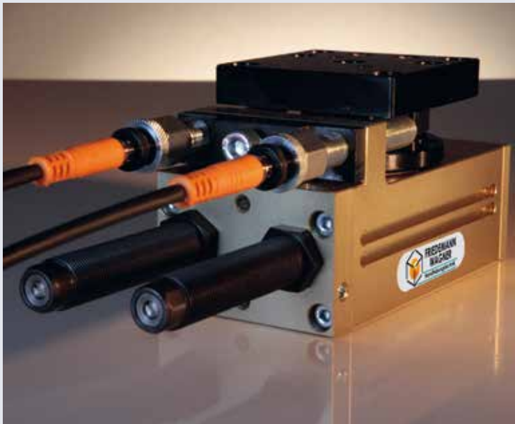
Pneumatischer Schwenkantrieb mit Sensoren, Anschlagsschrauben und Dämpfern, bei dem alle Störkanten auf einer Seite liegen
