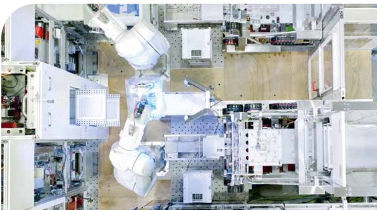
Stationäre Roboter verpacken die Halbleiterplatten 100% luftdicht
