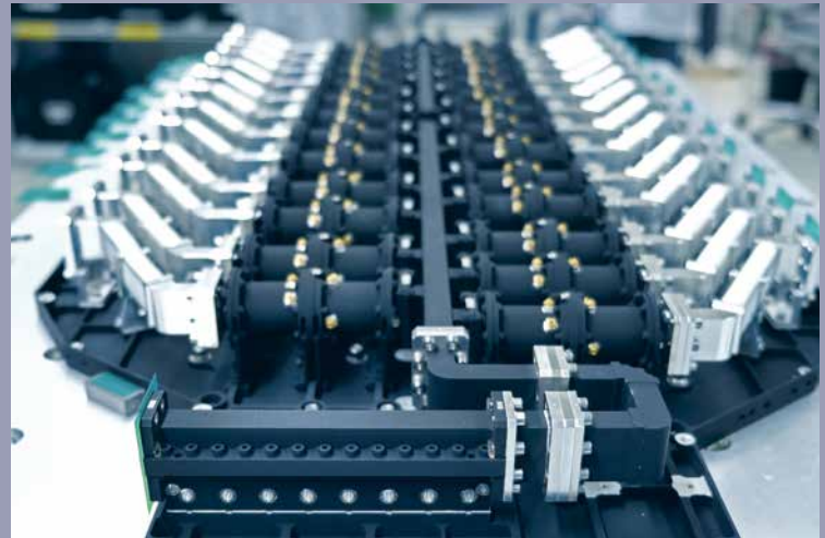
Weltweit gefragt: Herringbone Output Multiplexer
