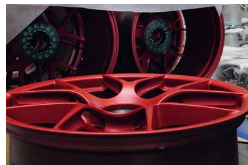
Jedes Rad ein Unikat: Lackiertes Magnesium-Schmiederad Porsche GT3RS
