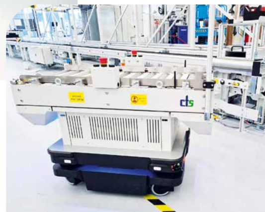
Ein AMR liefert Produktionsteile just-in-time an die Fertigungslinie
