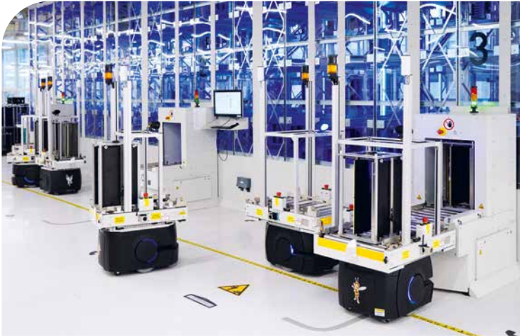
Smart Warehouse mit mobilen Robotern: Die Ein- und Auslagerung erfolgt komplett automatisch
