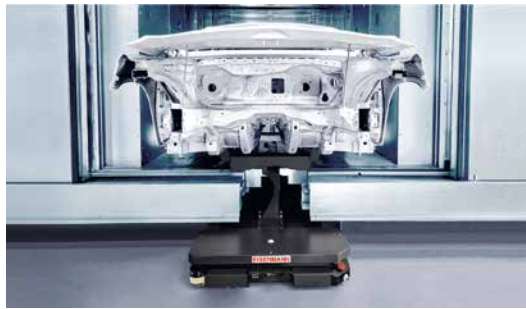
Der VarioMover, ein fahrerloses Transportfahrzeug mit Hubtisch
