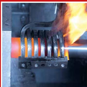
Bei Verarbeitung wird der Stahl einer induktiven Wärmebehandlung unterzogen
