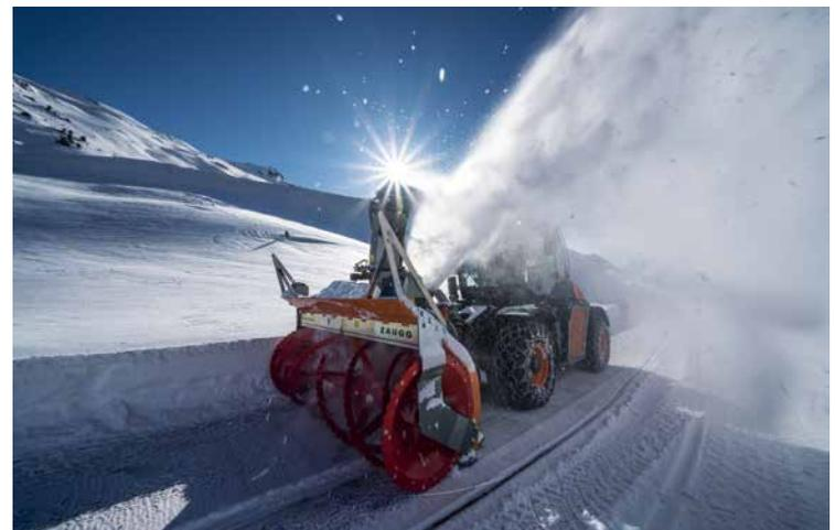
Die Schneefrässchleuder SF 110-125 ist speziell für den Anbau an große Geräteträger mit Arbeitsbreiten bis 330 cm konzipiert
