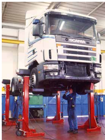
Die Säulen haben Hebekräfte zwischen 5 und 50 t
