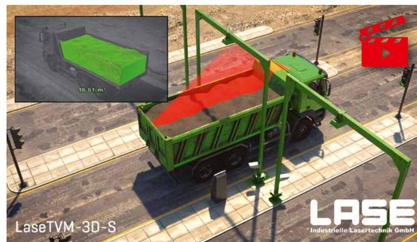
Schüttgutvolumenmessung auf einem Lkw: Mittels 3-D-Laser, der in einem Portal oberhalb der Fahrspur montiert ist, wird die geladene Menge gemessen
