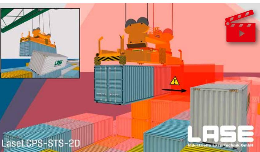
Load Collision Prevention System zur Vermeidung von Kollisionen zwischen der Ladung und dem Container auf dem Schiff
