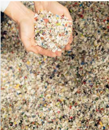
Vom Gelben Sack zum Bodenbelag: CERAMIN nutzt recyceltes Polypropylen als Sekundärrohstoff
