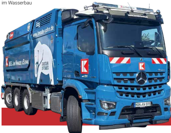
Ein Saugbagger, bereit für den Einsatz im Wasserbau
