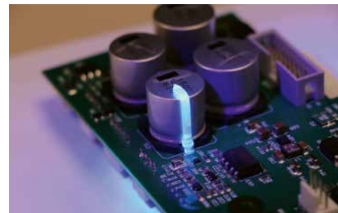
Lichthärtende Klebstoffe von Dymax sichern kritische Komponenten auf Leiterplatten
