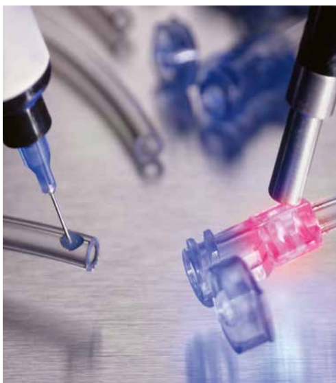
Binnen Sekunden lassen sich mit der Technologie von Dymax medizinische Komponenten wie Spritzen, Kanülen und Katheter sicher verbinden
