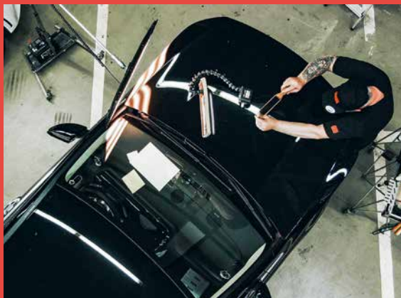
Blick von oben: Reparatur eines Hagelschadens am Fahrzeugdach
