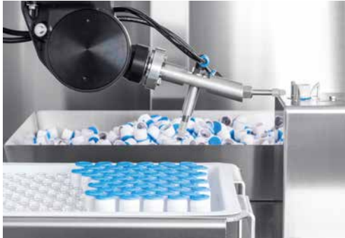
Ein Roboterarm übernimmt das Handling der Kappen für Vials
