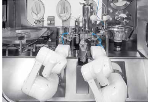
Die gravimetrische Abfüllung auf der Wägezelle garantiert höchste Dosiergenauigkeit
