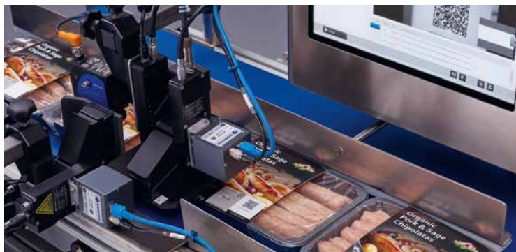
Gx-Serie PRO Thermal-Inkjet-Lösungsansatz für den bevorstehenden branchenweiten Wechsel vom Strichcode zum GS1 Digital Link QR-Code
