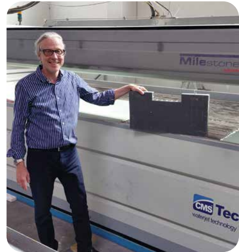
Das Wasserstrahlschneiden erlaubt eine besonders präzise und materialschonende Bearbeitung von Composites und Spezialkunststoffen | Nils Krüger, Geschäftsführer der Arthur Krüger GmbH
