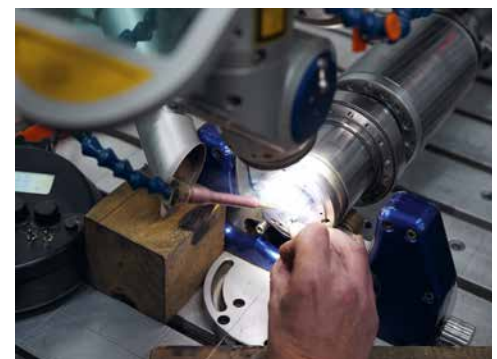
Laserschweißen im Einsatz: Präzise Instandsetzung hochbelasteter Bauteile ohne Materialverzug
