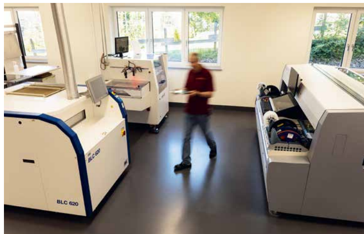
Ein Teil der Elektronikfertigung: Die SMD-Fertigungsinsel bei Wiesheu Elektronik – ausgelegt auf präzise Bestückung und reproduzierbare Qualität
