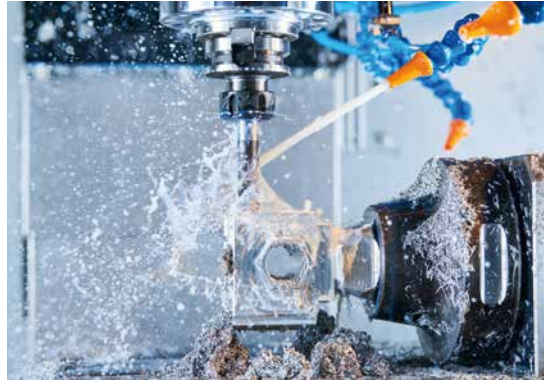
Im laufenden Prozess: Kühlschmierstoffe sichern Präzision, Standzeiten und gleichbleibende Qualität in der Fertigung
