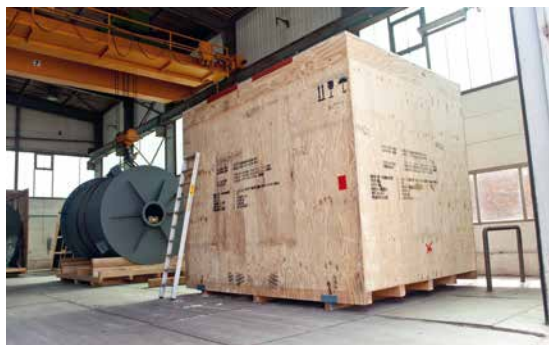
Maßarbeit aus Holz: Bei Peter Krings entstehen präzise Schwergutverpackungen, die Maschinen und Anlagen transportieren
