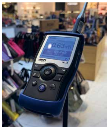
Bei der Sprachalarmanlage wird die Sprachverständlichkeit gemessen
