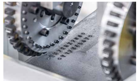
Spezialanlage zur VIN-Markierung: Soenen entwickelt bereits die 3. Generation seiner Maschinen zur dauerhaften Identifizierung von Lkw-Trägern
