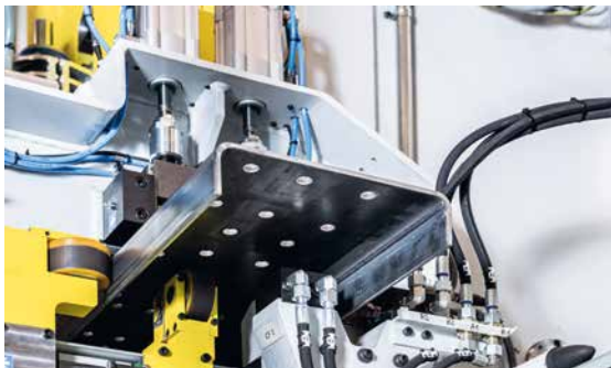
In Soenen-Stanzanlagen entstehen Lkw-Träger mit flexibel positionierbaren Löchern für die kundenindividuelle Montage
