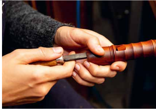
Präzision im Detail: Beim Feilen des Windkanals entscheidet sich, wie gleichmäßig und tragfähig der Ton später erklingt
