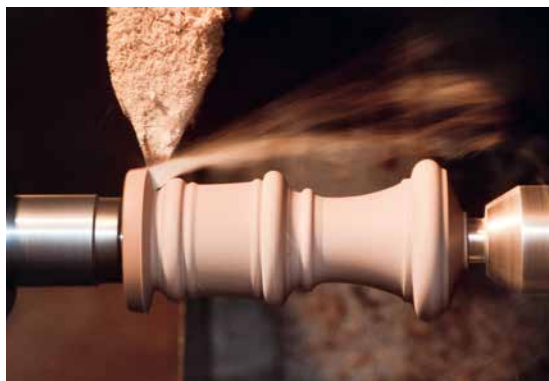
Drechseln eines Blockflötenfußes – digitale Präzision und traditionelles Drechselhandwerk
