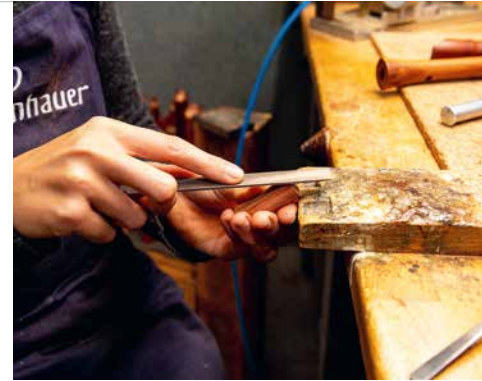
Durch das Feilen der Blockfase wird der Luftstrom im Instrument geformt
