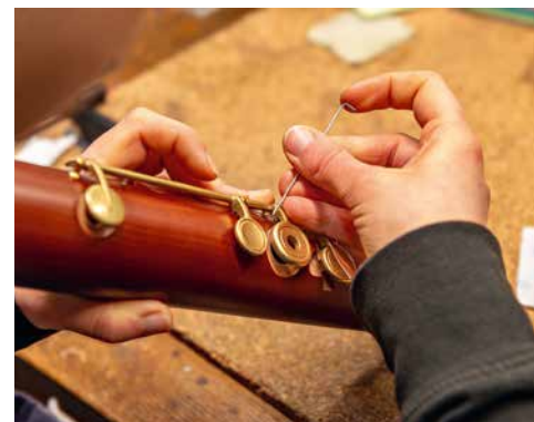
Feingefühl gefragt: Beim Einziehen der Feder erhält die Klappe ihre Spannung
