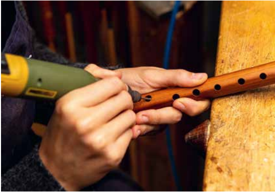
Beim Stimmen der Tonlöcher wird jede Blockflöte individuell angepasst, bis Intonation und Klangfarbe exakt harmonisieren
