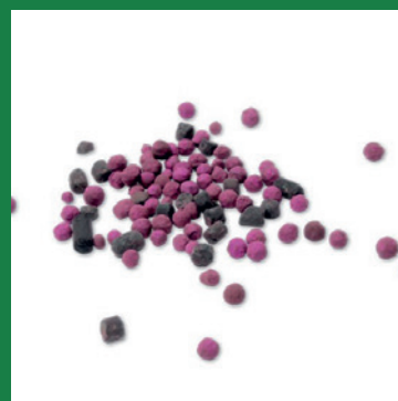
Korrosionsschutz in der Gasphase
