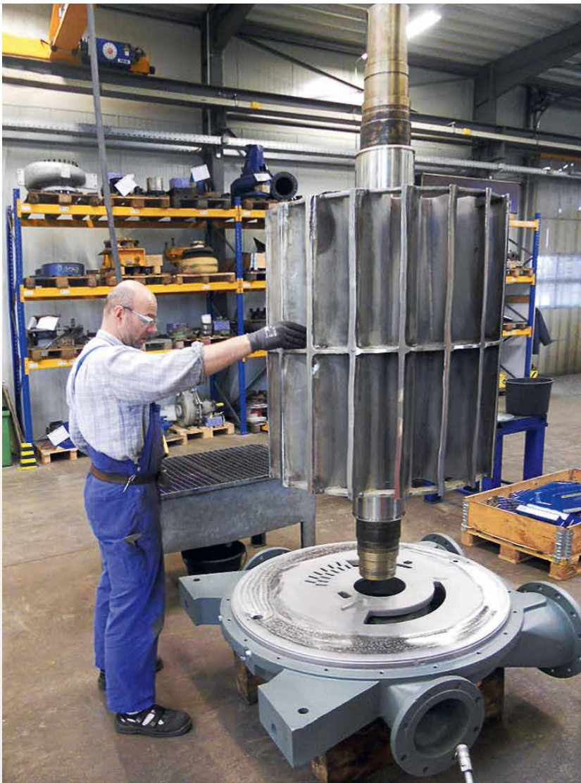
Mitarbeiter beim Zusammenbau einer WasserringVakuumpumpe
