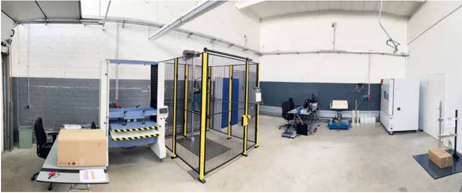
Transportsimulationen für sterile und nicht-sterile Produkte berücksichtigen klimatische und mechanische Belastungen
