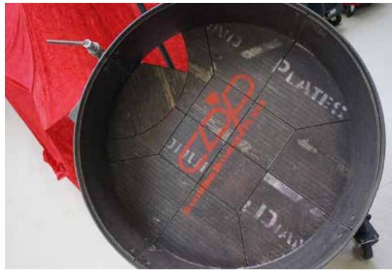
Betonmischer, welcher nach Kundenvorgaben in den eigenen Castolin-Werkstätten zugeschnitten und einbaufertig geliefert wird
