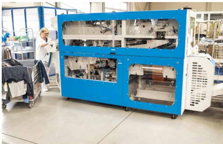
Automation und manuelle Arbeit gehen Hand in Hand: hier eine Faltmaschine
