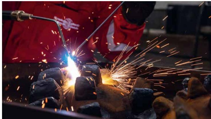
Die Spezialität von Castolin Eutectic ist Oberflächenschutz anspruchsvoller Bauteile durch Schweißen, Löten und thermisches Beschichten
