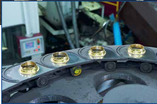
Synchronringe von OTTO FUCHS Dülken sorgen in Automobilgetrieben für präzises Schalten und höchste Verschleißfestigkeit
