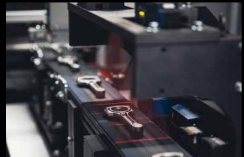
Laserbasierte Endkontrolle zur Sicherstellung höchster Qualität
