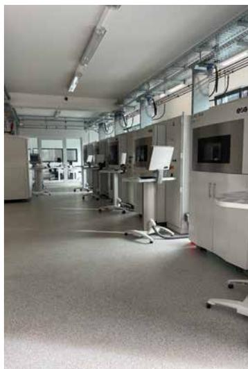
LMD fertigt Einzelstücke, Kleinserien und Prototypen mithilfe von Laser-Sinter-Technologie
