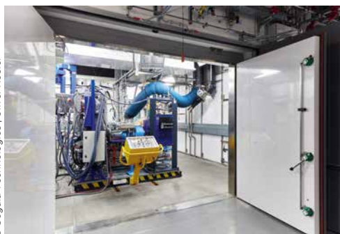
Dyno Testing Klimatestzelle mit Höhensimulation im SEGULA Technologies Engineering & Testing Campus Rüsselsheim
