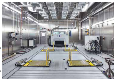
Propulsion Test Center Dyno Prüfstand mit Klimakammer im SEGULA Technologies Testcenter Rodgau-Dudenhofen
