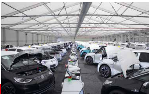
Dank einer Ladeinfrastruktur von 1.150 kW können große Feld- und Gewährleistungskationen durchgeführt werden
