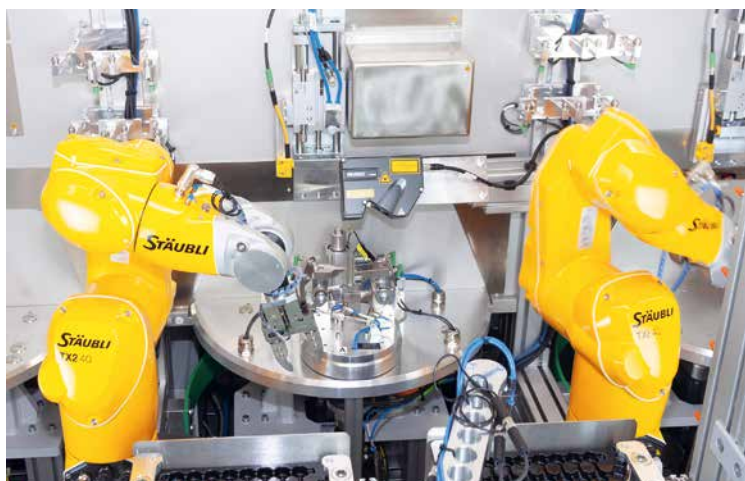
Roboter bedienen eine Laserschweißanlage
