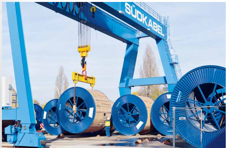
Verladen einer Höchstspannungskabeltrommel
