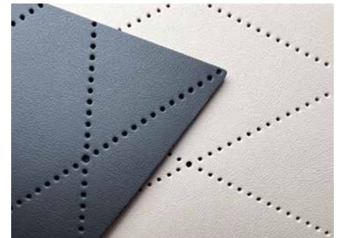
Perforation von Zuschnitten mit rückseitiger Kaschierung, ohne dass Klebstoff in den Löchern zu sehen ist
