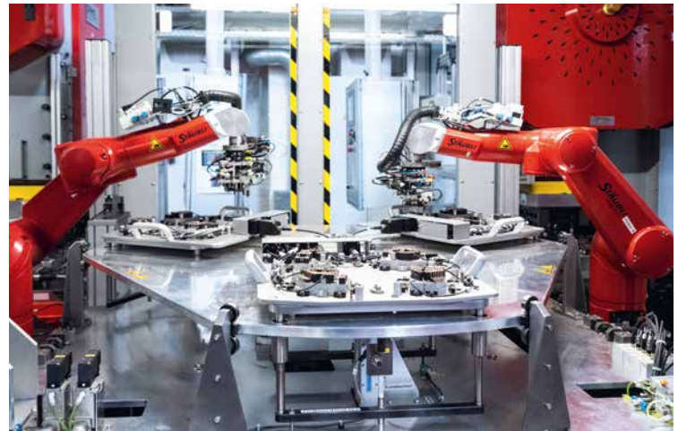
Hochmoderner Maschinenpark: Vollautomatische Bereitstellung für das Spritzgießen
