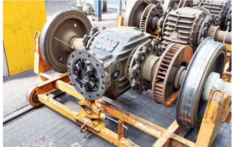
Öl, das extremen Bedingungen standhalten muss: ADDINOL Industriegetriebeöl in Radsatzgetrieben von Straßenbahnen
