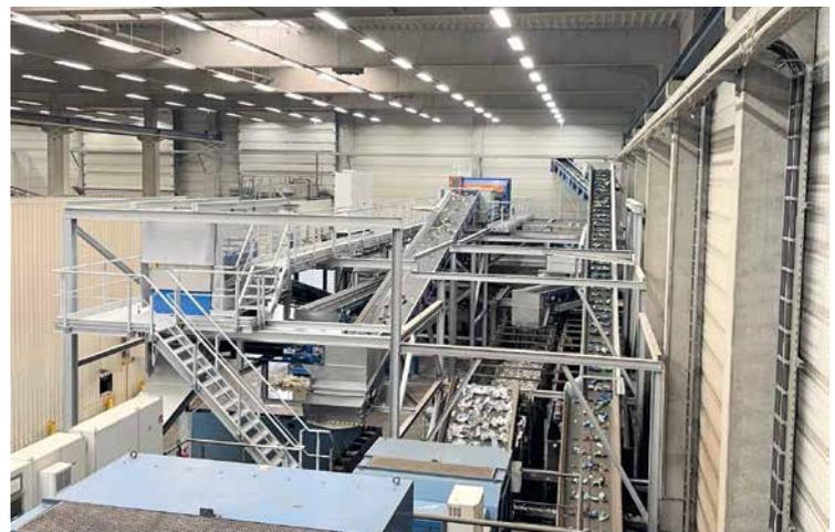
PET-Recyclinganlage zur Herstellung von PET-Flakes
