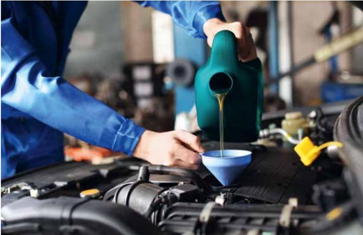
Befüllung mit Motorenöl
