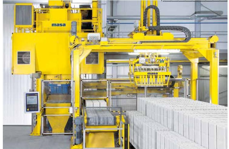
Hydraulische Masa-Kalksandsteinpresse mit Steinsetzautomat für Rohlinge
